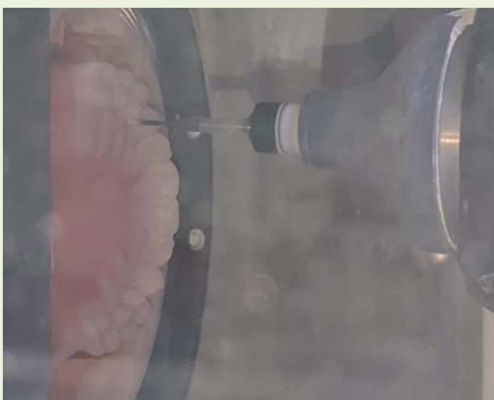
Figura 8. A. Fresagem da Prótese Total Removível superior; B. Disco Ivotion
