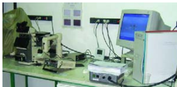
Figura 1 - Microscópio invertido, computador com suporte informático para medição dos dados, ocular filar e contador de medições digital
