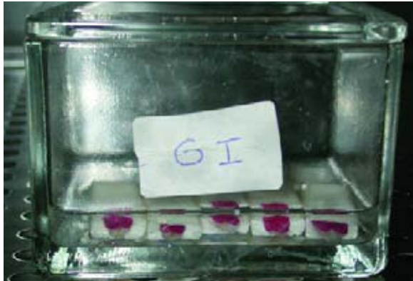
Figura 4 - Amostras do grupo I imersas em saliva artificial
