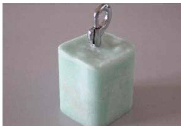
Figura 6 - Gancho utilizado para realizar os testes de tracção
