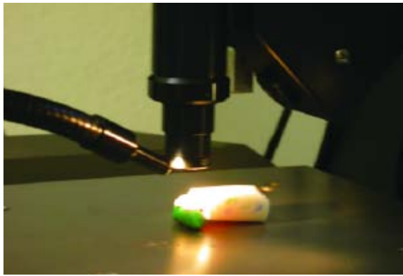
Figura 4 - Colocação das amostras no rugosímetro
