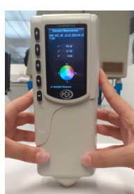
Figura 3. Medição da cor com o colorímetro.
