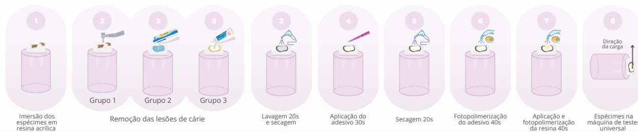
Figura 1. Diagrama da preparação dos espécimes e protocolo de restauração
