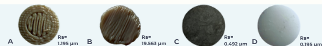
Figura 1: Discos dos grupos de estudo utilizados: A) PEEK impresso em 3D com orientação horizontal do filamento (PEEK H); B) PEEK impresso em 3D com orientação vertical do filamento (PEEK V); C) Titânio (cpTi); D) Zircónia (ZrO2).
