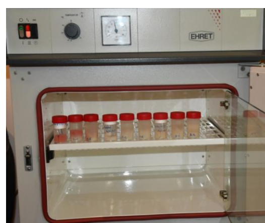
Figura 4 – Provetes imersos nas soluções a 37°.
