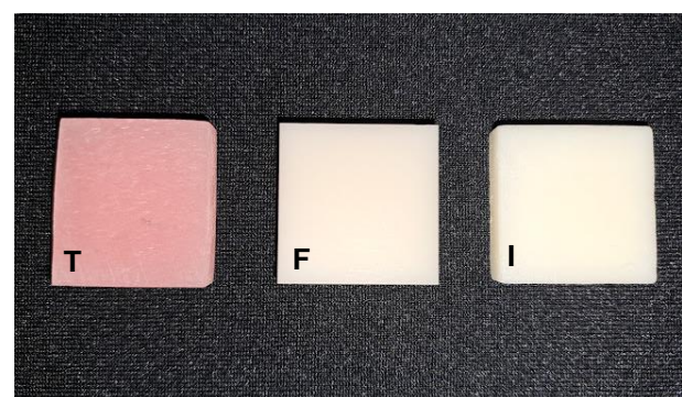
Figura 1 – Provetes confeccionados: termopolimerizável (T), fresado (F) e impresso (I).
