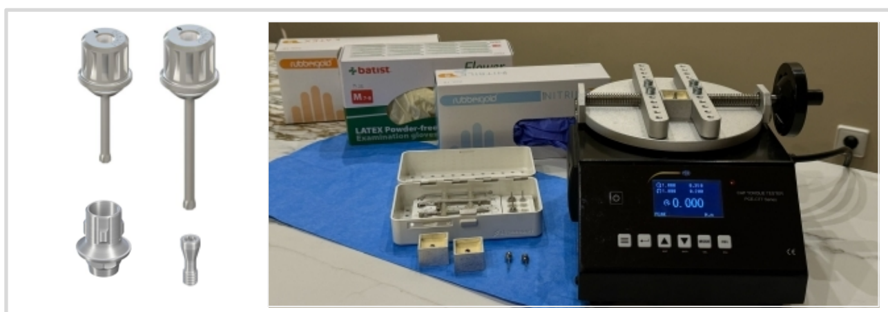
Fig 1. Materiais utilizados: chaves protéticas, pilar/parafuso (Straumann®) mesas de trabalho (implante Straumann® TL RN) e torquímetro de bancada.
