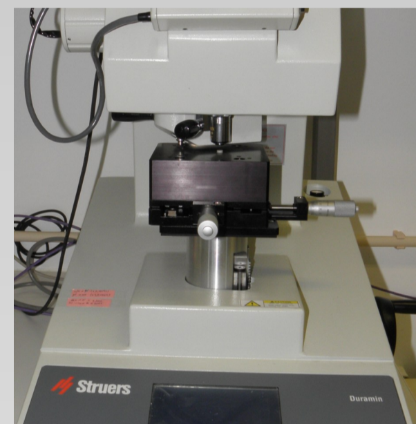
Figura 2. Determinação da microdureza Knoop (Duramin Struers, Ballerup, Dinamarca / 245mN, 10 segundos).
