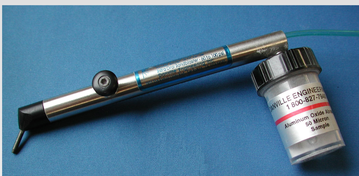
Figura 3. Jateamento com partículas de Al 2 O 3 de 50 µm (Danville Engineering Inc, Danville, CA, USA).
