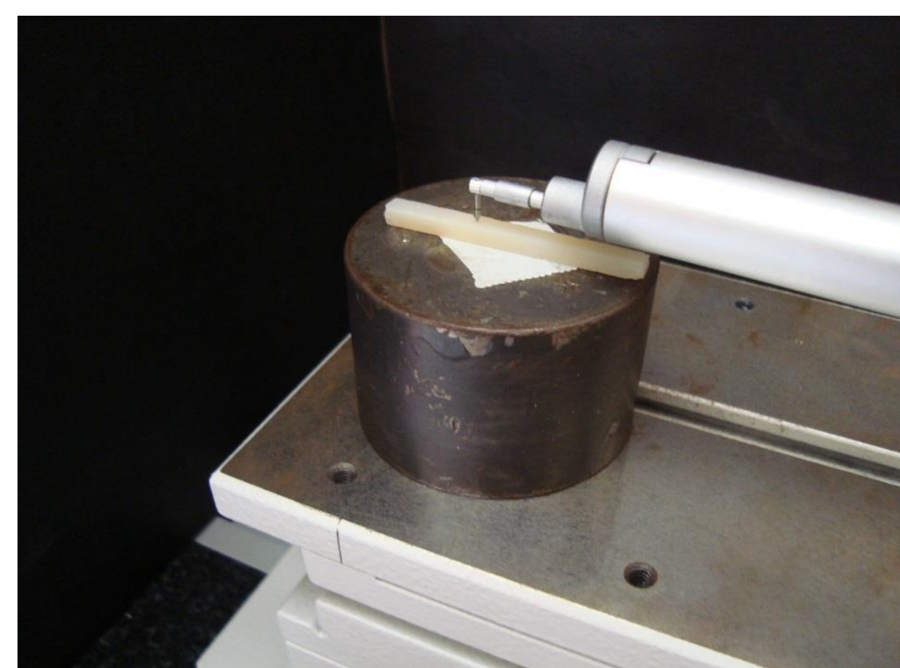
Figura 3. Medição da rugosidade.
