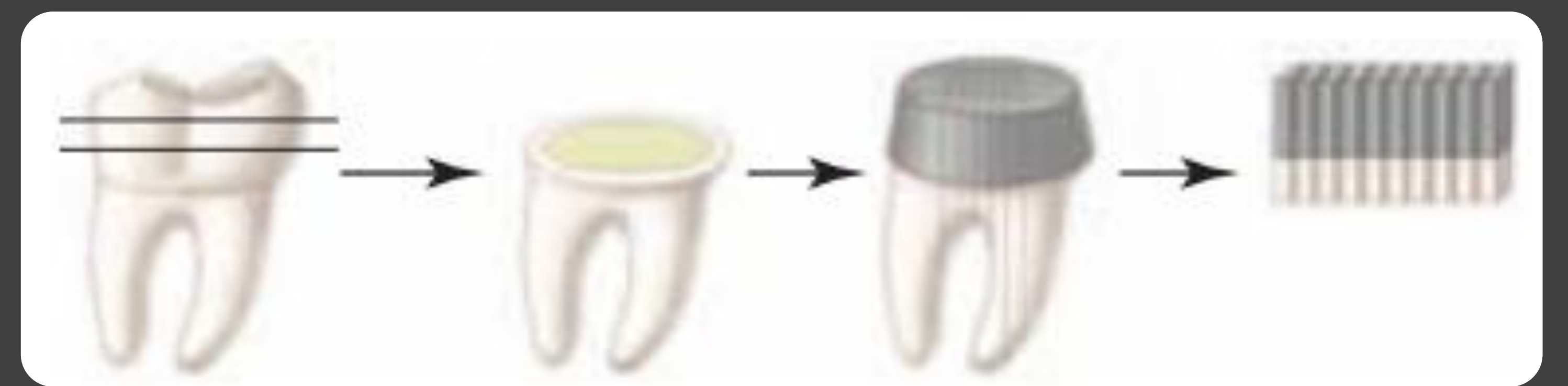
Fig. 2 - Preparação das amostras para o Teste de Microtração (Fonte: Perdigão et al., 2002)
