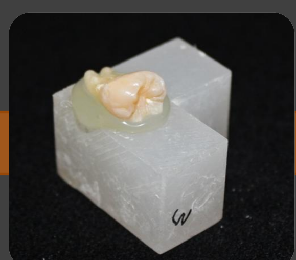
Fig. 3 e 4 - Montagem de um dente no dispositivo de fixação e corte com lâmina de diamante
