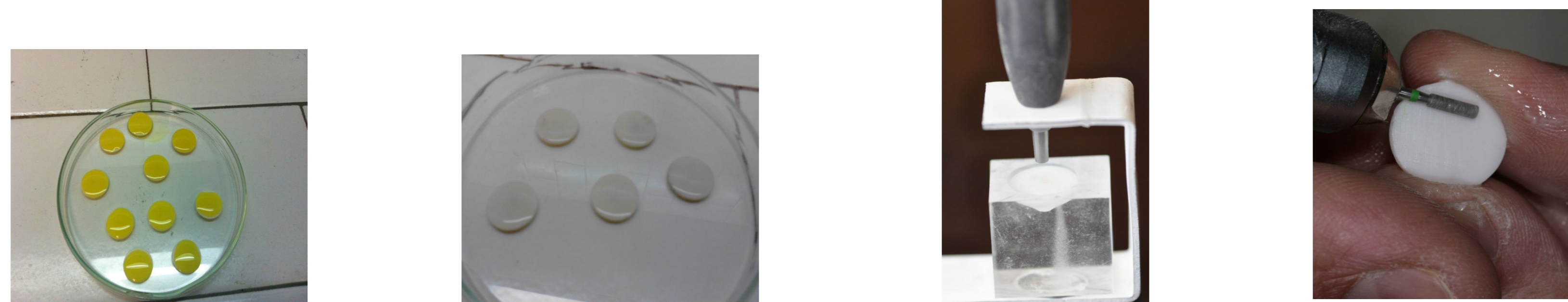
Figura 1 – Espécimes tratadas, respectivamente, com ácido quente, ácido hidrofúorídrico, jato de óxido de Al 2 O 3 e broca diamantada.
