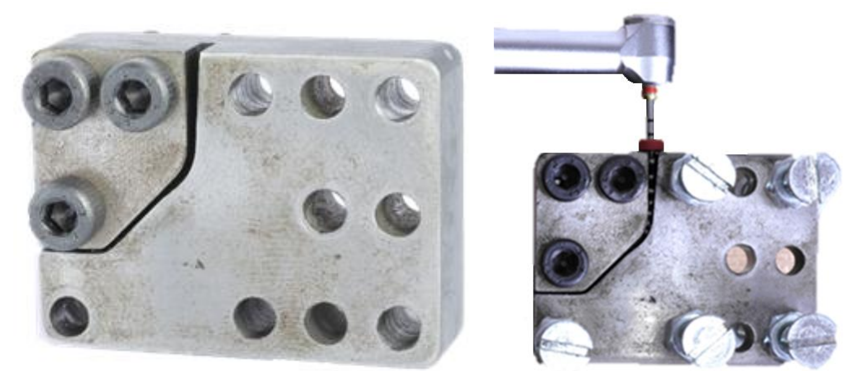
Figura 2: Canal artificial após maquinagem dos blocos de aço e encaixe das duas peças. Ensaio estático da fadiga cíclica.
