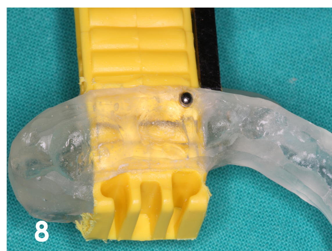
Fig. 8 – Colagem de uma esfera calibrada de 2mm de diâmetro para calibração de medições lineares.
