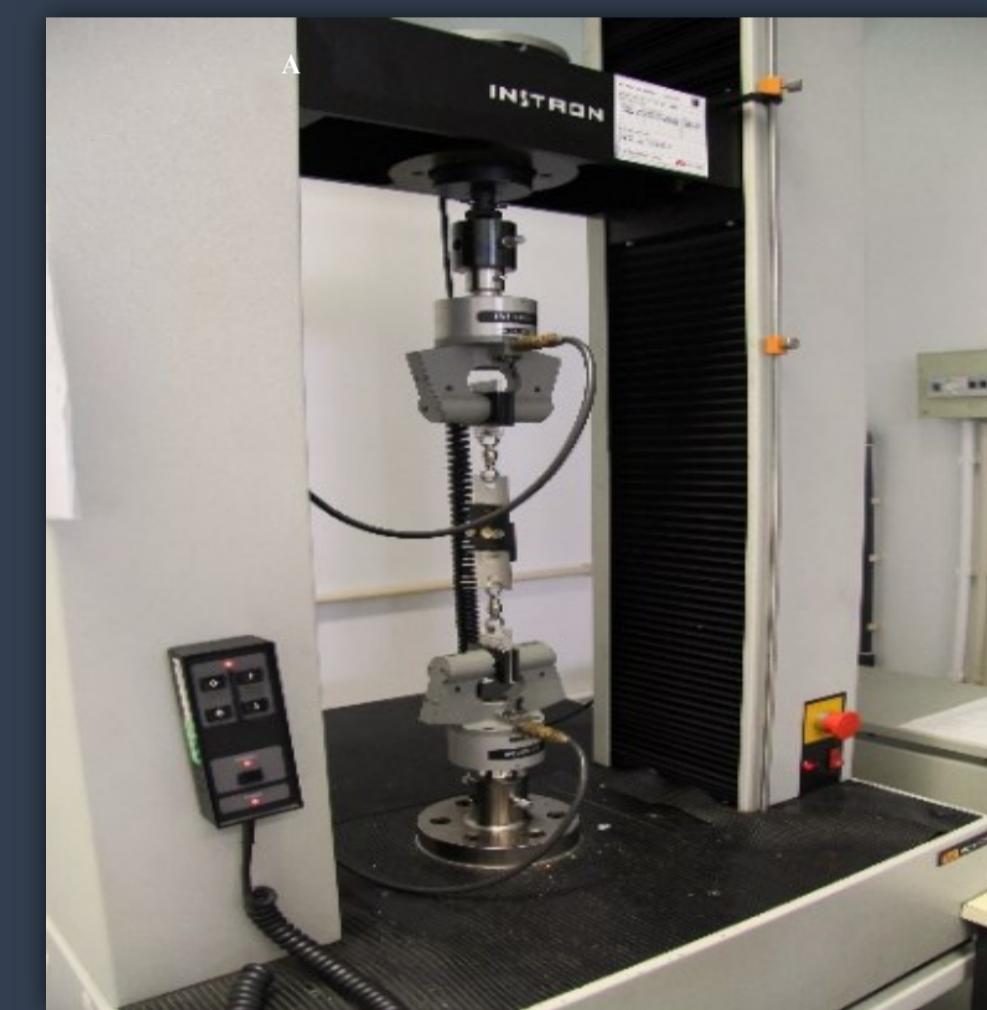
Figura 4 – Montagem das placas de Watanabe e execução de testes de resistência adesiva numa máquina de testes mecânicos universal Instron 4502
