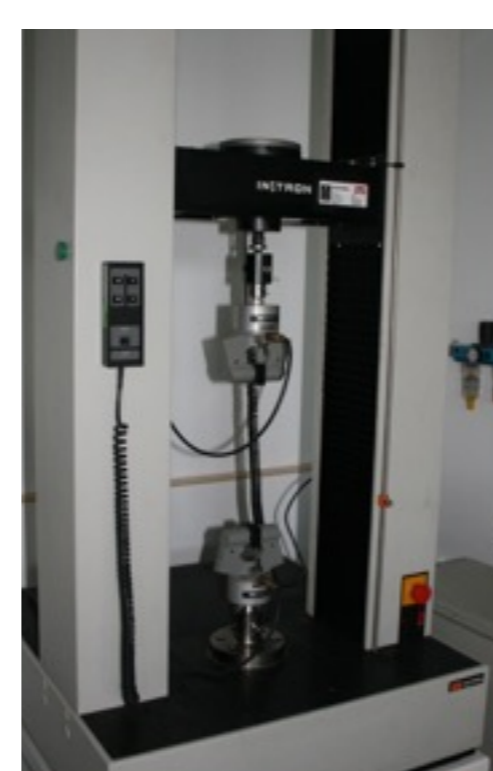
Figura 5: máquina de teste de resistência adesiva a tensões de corte (Instron).
