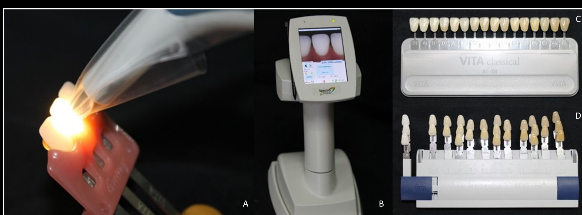
Figura 1 - Ponta da sonda ótica do Easyshade colocada no terço médio da superfície da guia de cor (A); Spectroshade (B); Escalas Vita Classical, com as 16 guias de cor (C) e Vita 3D-Master com 29 guias de cor (D).
