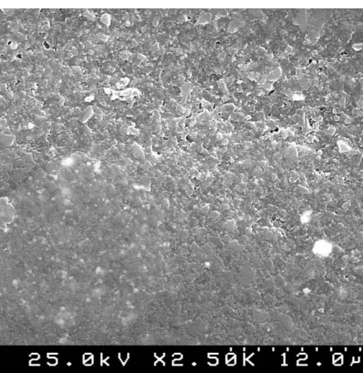
Fig. 28 – Imagem de MEV da superfície do Tetric EvoCeram® pós-escovagem.
