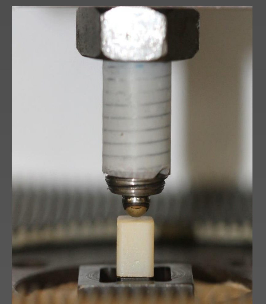
Figura 8 – Teste de resistência na máquina TIRA test 2705 .
