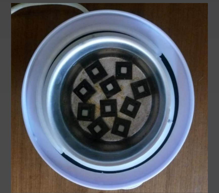
Figura 7 – Dez conjuntos coroa-coto colocados em água destilada a 37°C.
