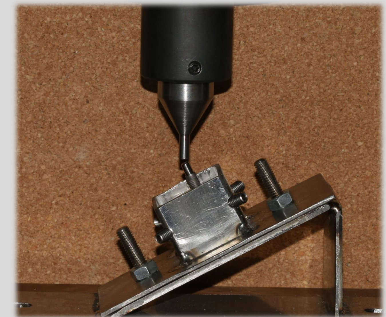
Fig. 2: Implante montado em base metálica (30°) para realização dos testes de compressão.
