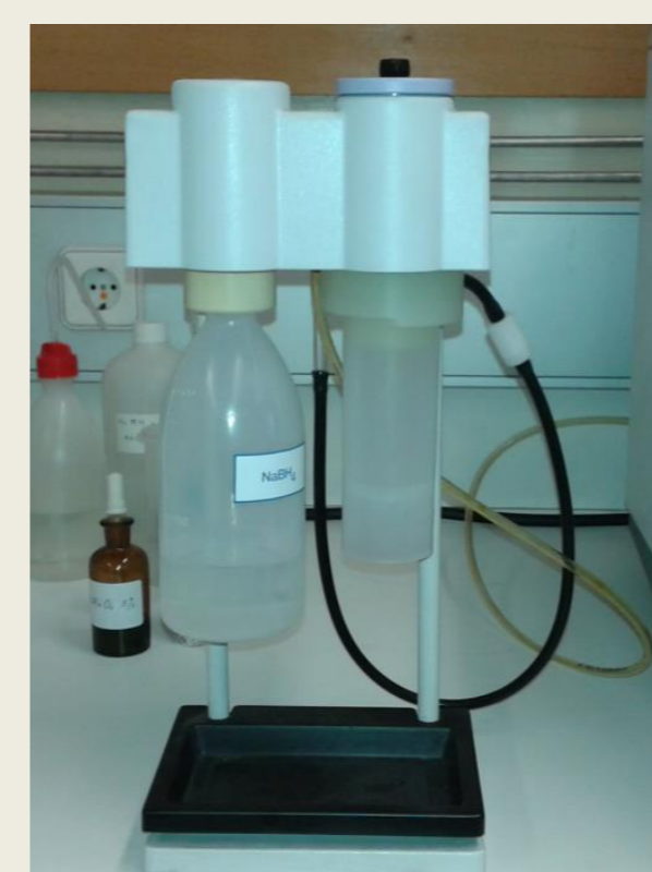
Figura 4. Sistema redutor do mercúrio.
