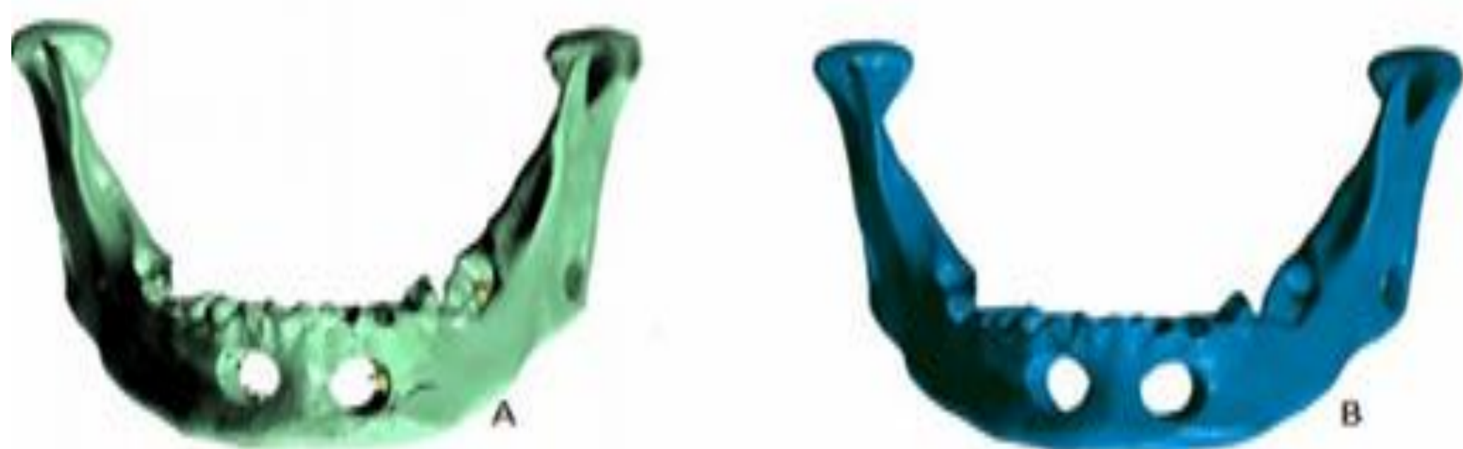
Figura 5 (A, B): Arquivos gerados pelo Programa Geomagic®. Em A, arquivo em nuvem de pontos. Em B, arquivo em STL
