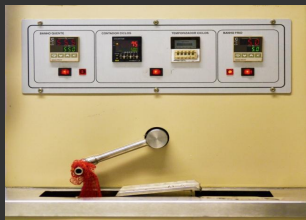
Figura 3 - Termocicladora (Refrí 200-E, Aralab).
