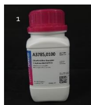
Figuras 1,2 e 3- A CHX (Panreac Applchem, Darmstadt, Germany) foi incorporada na massa do pó das resinas acrílicas. O pó e líquido de cada resina foram misturados, sendo a mistura obtida vertida para moldes de aço inoxidável padronizados (ISO 20795-1: 2013). Após reação de polimerização foram obtidos espécimes com as dimensões 6,4 x 10 x 3,3 mm.
