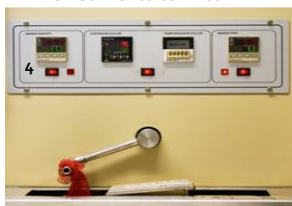
Figura 4- Envelhecimento térmico intraoral de 1 mês reproduzido por procedimento de termociclagem em máquina Refri 200-E, Aralab.
