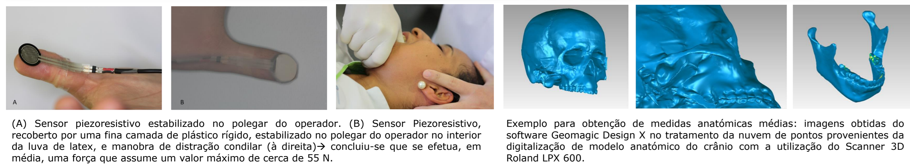
(A) Sensor piezoresistivo estabilizado no polegar do operador. (B) Sensor Piezoresistivo, recoberto por uma fina camada de plástico rígido, estabilizado no polegar do operador no interior da luva de latex, e manobra de distração condilar (à direita) → concluiu-se que se efetua, em média, uma força que assume um valor máximo de cerca de 55 N.
