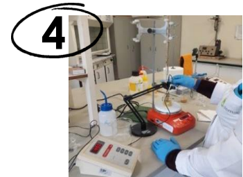
Fig. 4: Titulação ácido-base das soluções para determinação da acidez titulável
