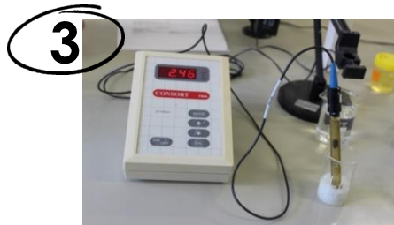
Fig. 3: Determinação do pH das pastilhas Trident® Max Splash morango e lima (Mondelez Portugal) utilizando um medidor de pH digital (modelo Consort P800)
