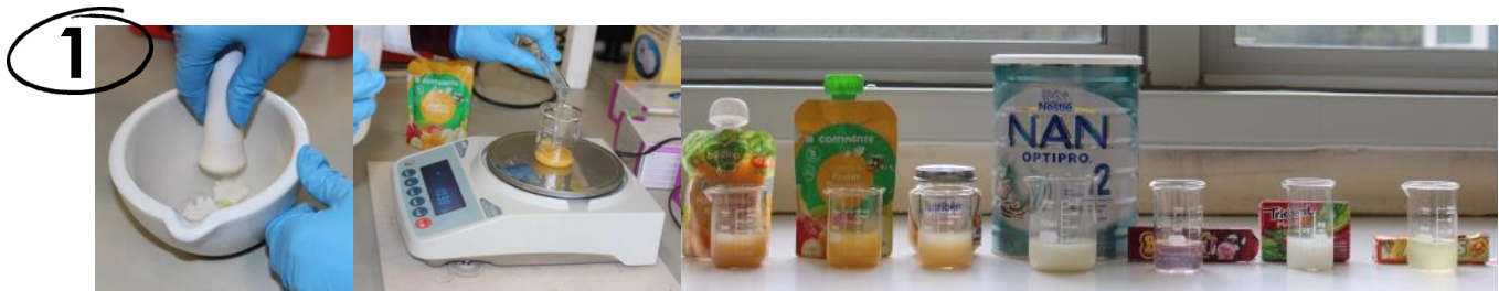
Fig. 1: Consoante o produto a ser testado, o pré-tratamento diferiu, cumprindo protocolos previamente descritos: as papas de fruta (10,4g) foram dissolvidas em água desionizada (20 mL); as pastilhas e os rebuçados foram moídos (4g de rebuçado/pastilha em 20 mL de água desionizada) com um almofariz e um pilão durante 5 minutos; o leite adaptado foi preparado conforme as indicações do fabricante (1 colher medida para cada 30 mL) e posteriormente dissolvido em 20 mL de água destilada. Foi utilizada uma balança de precisão (A&D Company Limited, Japão) para as medições de massa efetuadas. Na figura acima ilustram-se alguns passos do protocolo e as soluções resultantes obtidas
