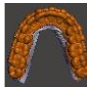
Fig. 13: Definição e colocação de espaçador de 1mm no programa Meshmixer.
