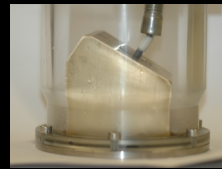
Fig. 1 Suporte para os espécimes na máquina de testes de fadiga.
