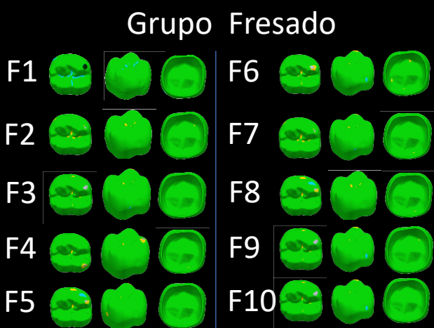
Figura 2: Várias perspectivas de dos mapas cromático da sobreposição das coroa fresadas com o desenho original com um limite de tolerância de \pm 100 \mu\text{m} . O grupo de coroas fresadas apresentou um RMS Global de 40,04 \mu\text{m} [25,10;54,98] sem diferenças estatisticamente significativas para as coroas impressas
