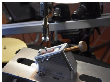
Figura 1 – Suporte da costela na máquina de testes (INSTRON® ElectroPulsTM E10000, Norwood, MA, USA), de acordo com a norma ISO 14801:2016.
