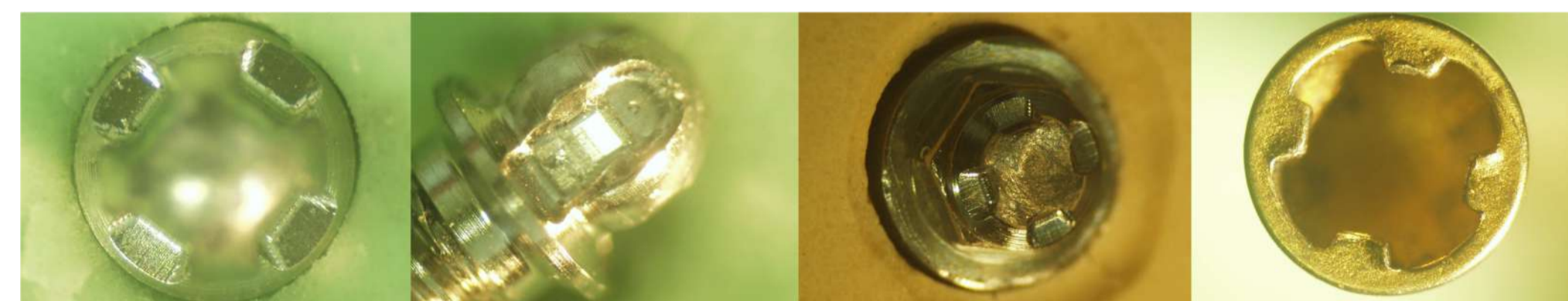
Fig. 6: Chave de aperto e da cabeça do parafuso do sistema BHS30® após a aplicação do torque máximo
