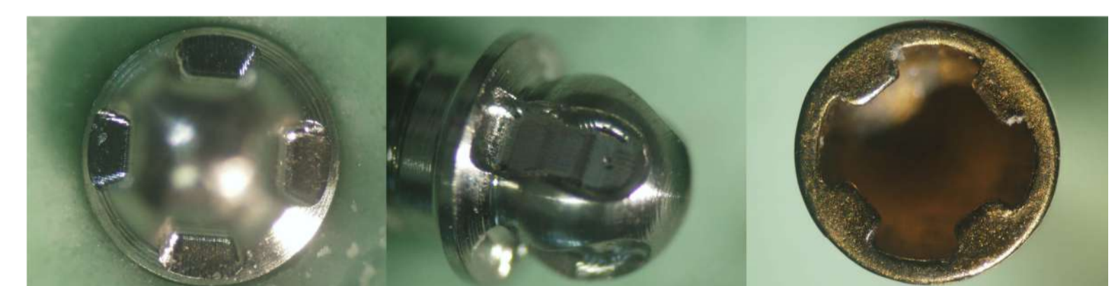
Fig. 5: Fotografias Iniciais da chave de aperto e da cabeça do parafuso do sistema BHS30®
