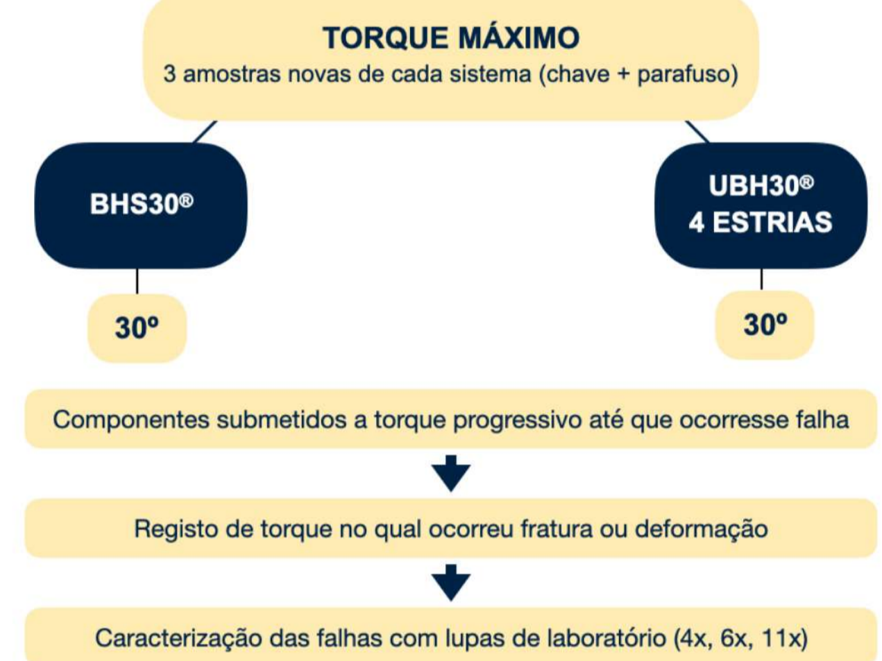
Fig. 3: Esquema representativo do protocolo laboratorial efetuado
