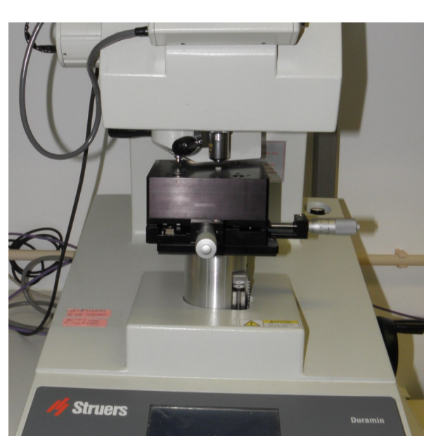
Figura 1. Determinação da microdureza Vickers (Duramin Struers, Ballerup, Dinamarca / 490,6mN, 10 segundos).
