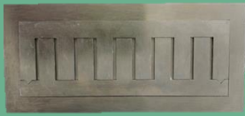
Fig. 1 - Molde de aço inoxidável (normas ISO 4049:2000 e dimensões 25x2x2 mm).
