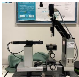
Fig. 3. Tensiómetro ótico Contact angle system OCA15 (Dataphysics Instruments).
