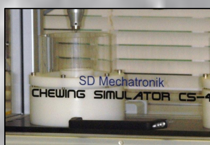
Fig. 16 - Câmaras do Chewing Simulator
