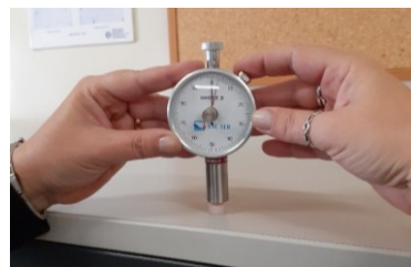
Figura 3 - Medição da dureza com um durómetro manual.
