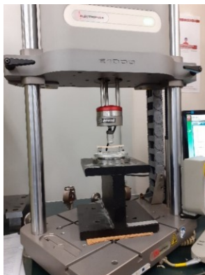
Figura 2 - Máquina de teste universal utilizada para a realização do teste de flexão em 3 pontos.
