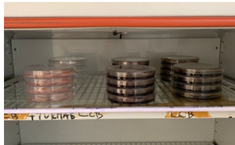
Figura 2 – Provetes imersos nas soluções e colocados na estufa.
