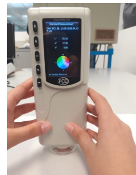
Figura 3 – Medição da cor com recurso ao colorímetro
