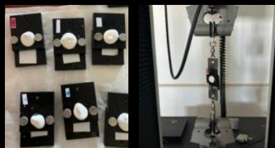
Fig. 7 e 8) Placas de Watanabe com gesso tipo IV pós presa e máquina de testes universal servo-hidráulica 4502 (Instron Ltd, Bucks, HP 12 35Y, Inglaterra)
