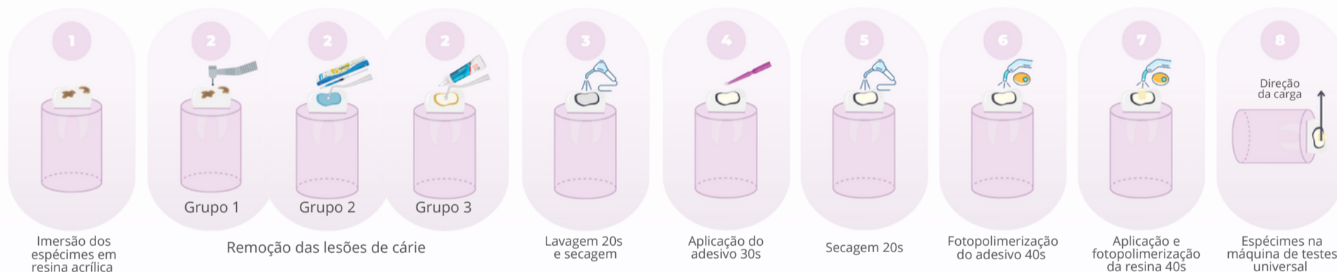
Figura 1. Diagrama da preparação dos espécimes e protocolo de restauração
