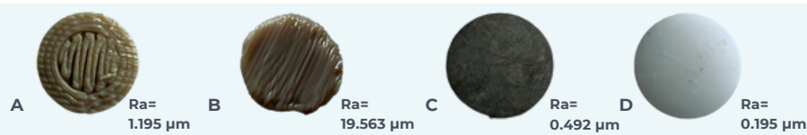
Figura 1: Discos dos grupos de estudo utilizados: A) PEEK impresso em 3D com orientação horizontal do filamento (PEEK H); B) PEEK impresso em 3D com orientação vertical do filamento (PEEK V); C) Titânio (cpTi); D) Zircónia (ZrO 2 ).
