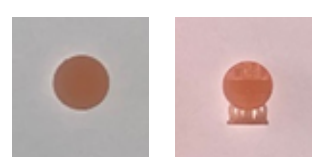
Figura 1: A: Provetes impressos a 0°; B: Provetes impressos a 90°
