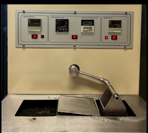
Fig.4: Envelhecimento físico na máquina de termociclagem (Refri 200-E, Aralab, Portugal).
