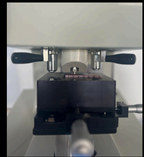
Fig.6: Teste de microdureza com ponta indentadora Knoop (Duramin, Struers DK 2750, Denmark).
