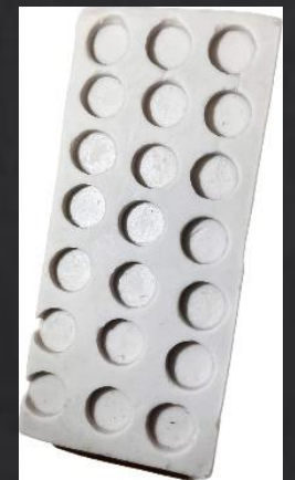
Figura 2- Molde de silicone para obtenção dos espécimes convencionais
