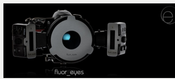
Fig.6 - Máquina fotográfica Nikon DSRL D700, lente macro 105mm, flash twin RB 200, sigma 140 DG, filtro fluor eyes (Bio-Emulation, Alemanha); Parâmetros da máquina: f=22, t=1/125 e ISO=400.
