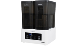
Fig.2 - Lavagem com álcool etílico 97% 5 min + 5 min.
