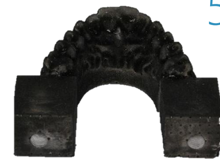
Fig. 1.: Modelo experimental de arcada dentária impresso por tecnologia SLA.
