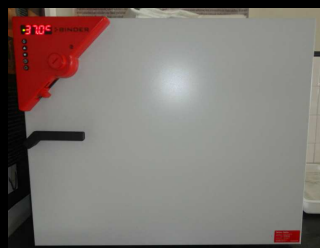
Figura 4. Estufa a 37°. Colocação de todas as amostras em água destilada numa estufa a 37° durante 24h.
