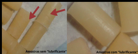
Figura 8. Amostras com e sem aplicação de "lubrificante". Verificou-se que quando se usaram os adesivos 5ª e 6ª G ou o álcool, as amostras ficaram lisas e uniformes. Observou-se a presença de bolhas de ar incorporadas nas amostras sem uso de "lubrificante".
