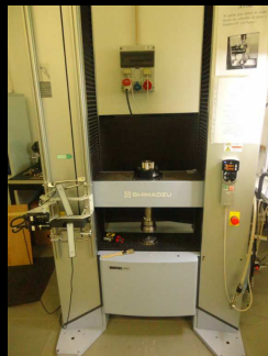
Figura 5. Máquina de ensaios universal ShimadzuAutograph AG-X 100kN.
