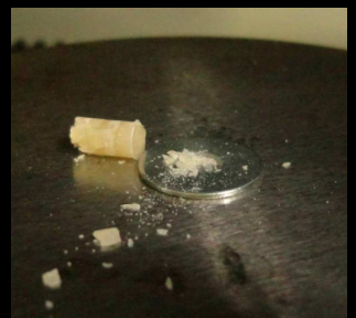
Figura 7. Fim do ensaio. Força compressiva axial constante até à fratura da amostra.
