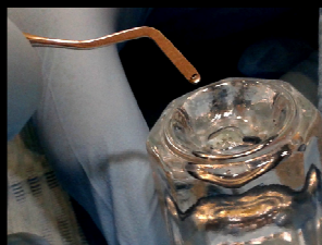
Figura 2. Controlo da quantidade de adesivo 5ª e 6ª G. Fez-se uma marca de 1mm na ponta ativa da espátula para controlar a mesma quantidade de adesivo para todas as amostras.
