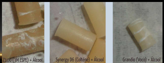
Figura 9. Amostras dos diferentes grupos manipulados com álcool. Nas amostras Z100(3M ESPE) e Grandio(Voco) verificou-se o aparecimento de uma superfície esbranquiçada.
