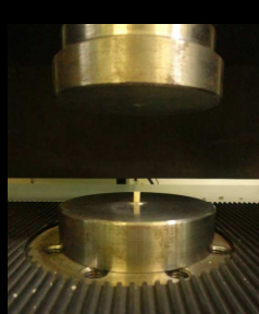
Figura 6. Início do ensaio. Força compressiva axial a uma velocidade constante de 0,5 mm/min.
