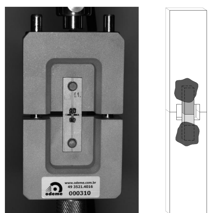
Figura 3. Imagem e esquema do teste de adesão por microtração.
